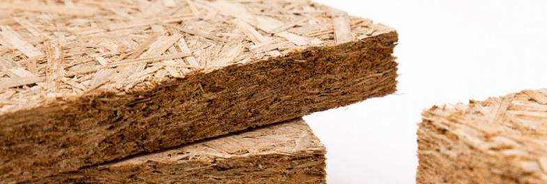
*Typhaplatten erfüllen sowohl statische als auch dämmende Aufgaben mit einer Bauteilschicht. © Bayerisches Landesamt für Denkmalpflege, Chr. Grube*
