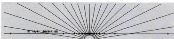
Bild 1: Homogener Strahlenfächer teilt Linienquelle (—) in Punktquellen (*) gleicher Immission auf
