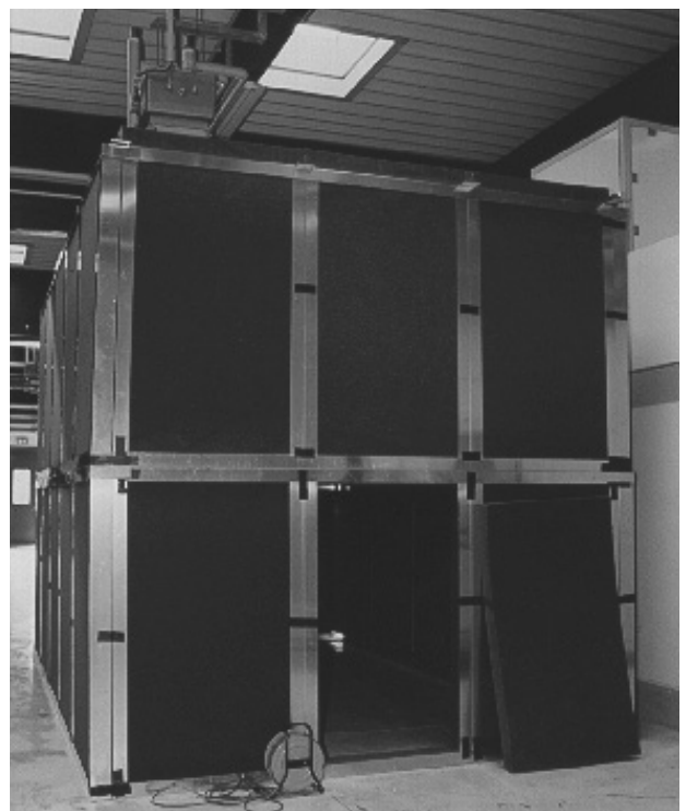
Bild 1: Ansicht eines Schallschirms aus Schaumstoffplatten und einer leichten Tragekonstruktion aus U-förmig gebogenen Aluminiumstreifen.
