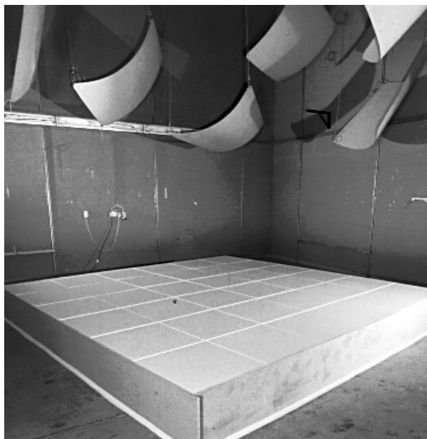
Bild 1: Photographische Aufnahme eines MPU-Prüflings im Hallraum des IBP
