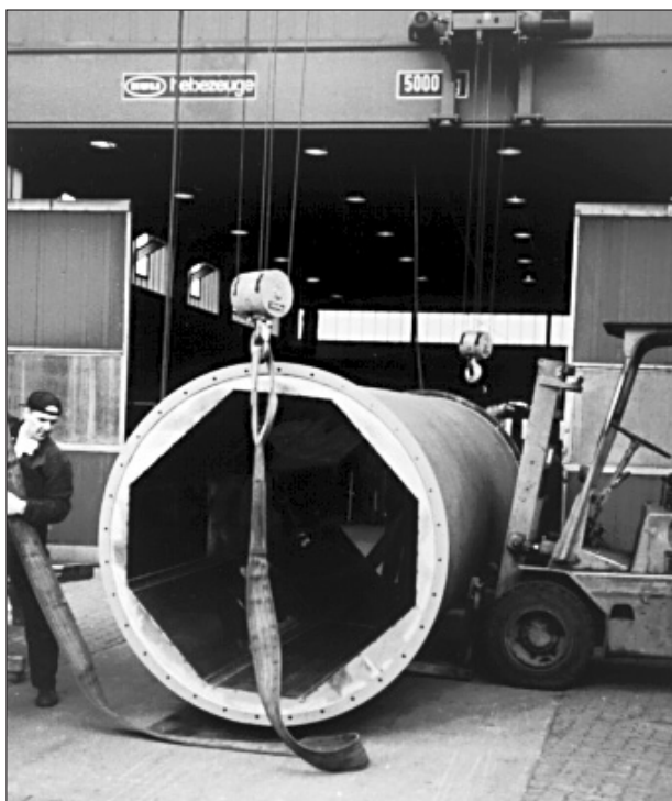
Bild 1: Photographische Aufnahme des 5 m langen Prototyps mit eckigem Innenzug.
