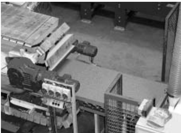
Bild 2: Photographische Aufnahme des REAPOR®-Grünkörpers beim Strangpressen.
