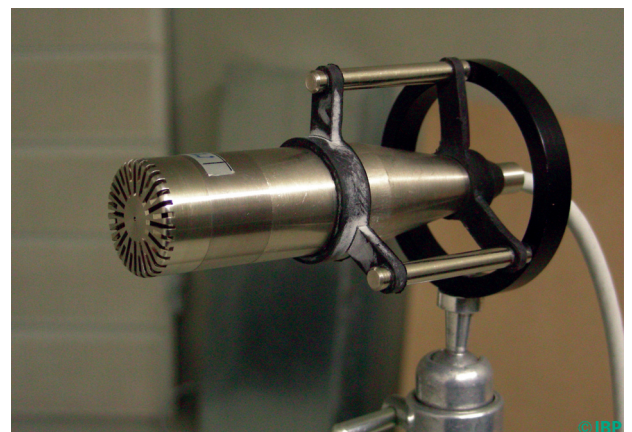
Bild 2: Hochempfindliches 1"-Mikrofon mit rauscharmem Vorverstärker und gummigelagerter körperschallentkoppelter Halterung
