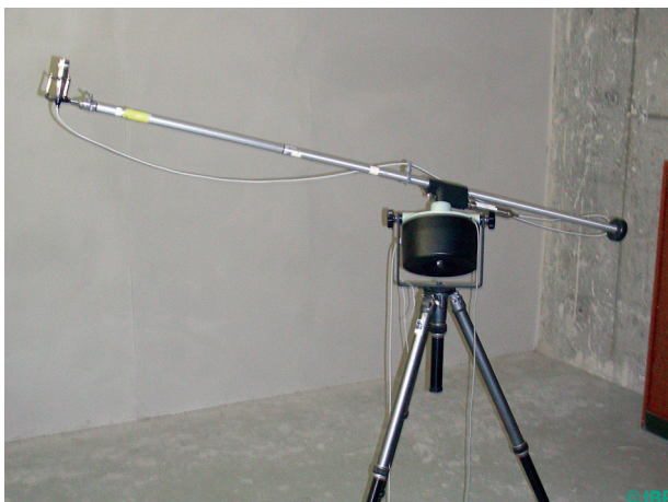
Bild 1: Schwenkanlage im Prüfraum
