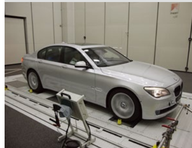
Akustikprüfstand mit BKA-Flachabsorbem
