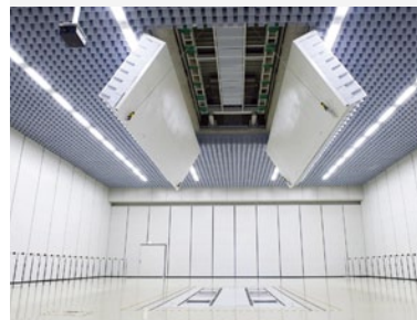
Akustischer Messraum für Vorbeifahrtgeräuschmessung
