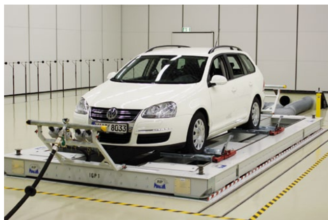
❶ Palette mit Luftkissen zum Transport vorgerüsteter Fahrzeuge
