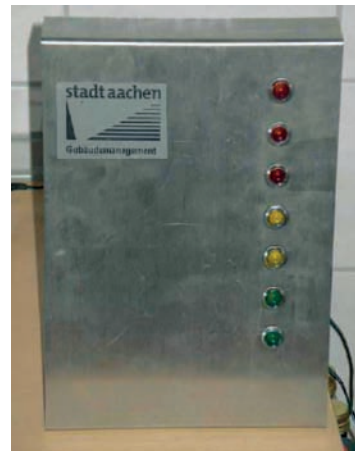
Lüftungsampel der Stadt Aachen. Sie zeigt in sieben Stufen die Luftqualität im Klassenraum an. Quelle: Lambert, Klima, Bähr, Ranft: Energetische Sanierung der Käthe-Kollwitz-Schule Aachen, Schlussbericht, 2006.
