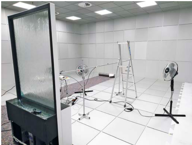
Bild 4. Versuchsaufbau der Feinstaubmessungen (Foto: Fraunhofer IBP) Fig. 4. Experimental setup of the fine dust measurements (photograph: Fraunhofer IBP)
