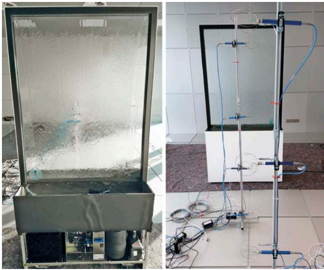
Bild 3. Der mobile Klimabrunnen mit Blick auf die unterhalb verbauete Kältetechnik (links); Messbäume im ersten Versuchsaufbau (rechts) (Foto: Fraunhofer IBP)
