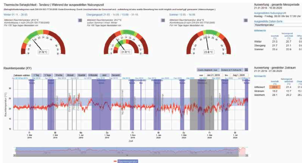
Abbildung 100: Auswertung der Lufttemperatur eines Gruppenraumes im Erweiterungsbau der Grundschule Giebelstadt für den Zeitraum Januar 2019 bis Juli 2020 in der Online-Plattform der Technischen Universität Dresden Quelle: TU Dresden
