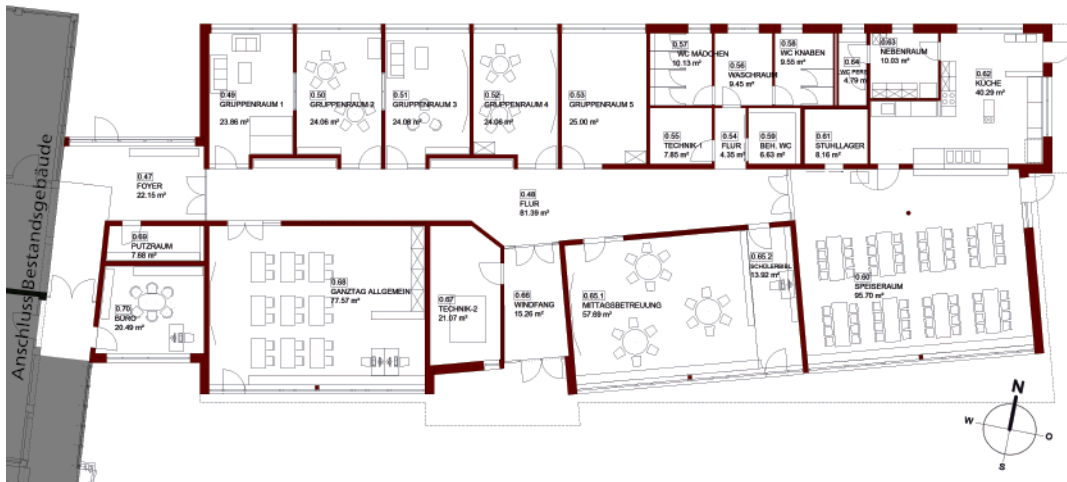
Abbildung 65: Erdgeschoss-Grundriss des Erweiterungsbaus Plan: Haase & Bey Architekten
