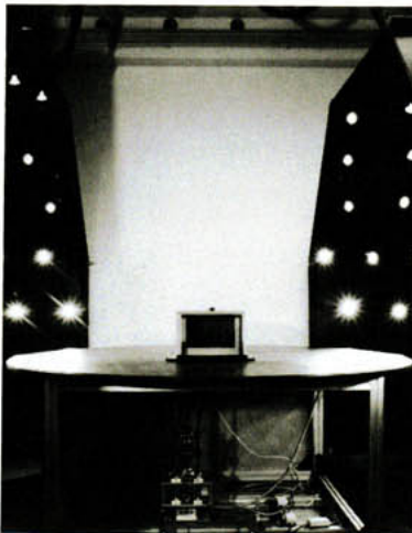
Bild 2: Aufnahme des geöffneten künstlichen Himmels. Unter dem Tisch ist der den Fußboden, das Photometer und die Endoskopkamera-Einheit bewegende Roboter zu sehen
