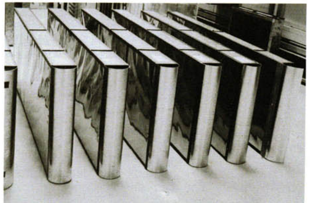
Bild 2: Kulissen-Schalldämpfer für den Einsatz im Steinkohlebergbau
