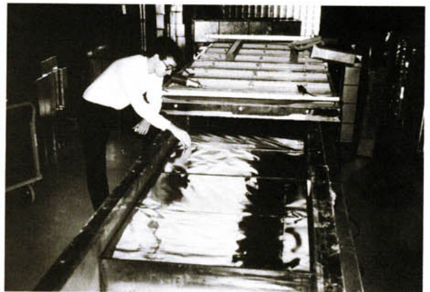
Bild 2: Prototypen eines Membran-Schalldämpfers aus Edelstahl in der Meßstrecke des Schalldämpfer-Prüfstandes im IBP
