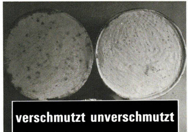
Bild 2: Gegenüberstellung einer künstlich verschmutzten und einer unverschmutzten Gipsoberfläche nach dreiwöchiger Untersuchungsdauer.
