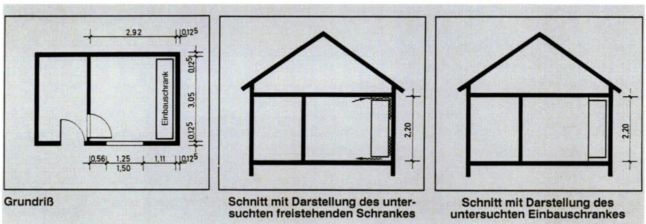
Bild 1: Darstellung des Testraumes und der untersuchten Schrankanordnungen zur Bestimmung der raumseitigen Wärmeübergangskoeffizienten an Außenwänden bei unterschiedlichen Heizsystemen, nach [3].
