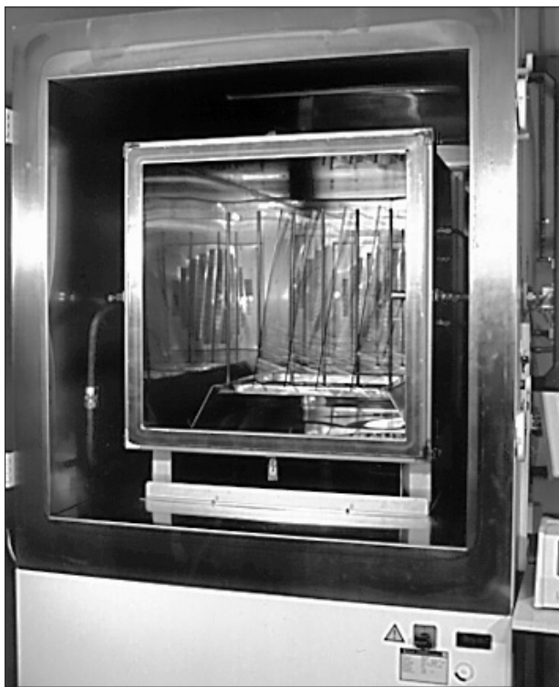
Bild 2: Fotografische Aufnahme der am IBP eingesetzten Emissions-Prüfkammer.
