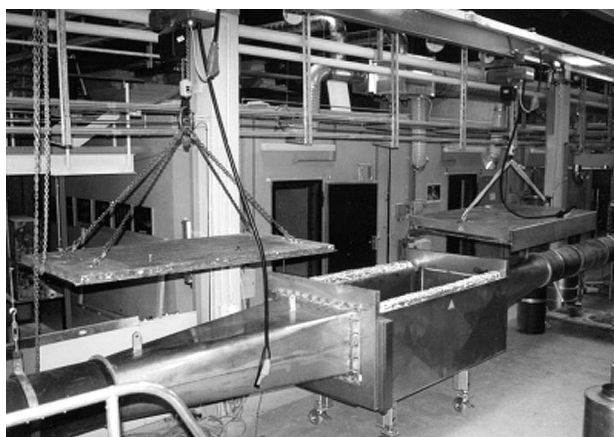
Bild 1: Fotografische Aufnahme der Temperaturbox für Schalldämpfer-Kulissen
