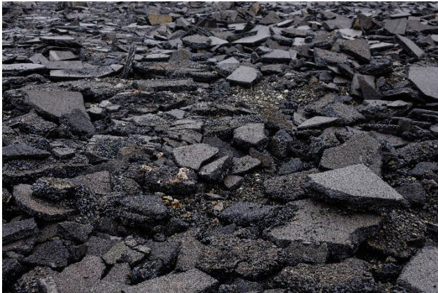
Abbildung 1: Straßenaufbruch enthält häufig hohe Konzentrationen an gesundheitschädlichem Teer und muss daher aufwendig entsorgt werden.
