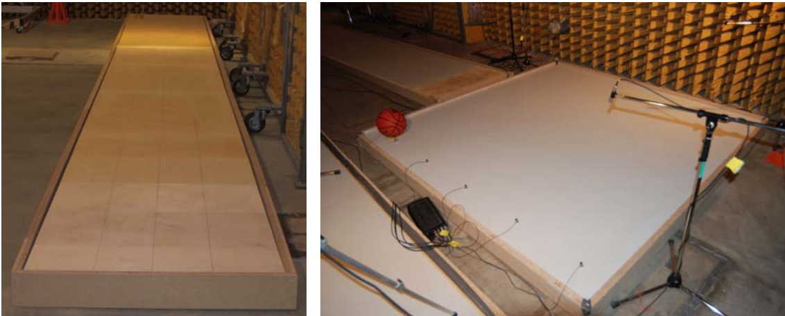
Bild 5.6 Links: Bodenausschnitt mit 1 m x 10 m im Halb-Freifeldraum zur Messung der Schwingungsausbreitung entlang des Bodens Rechts: Bodenausschnitt mit 2,5 m x 2,5 m im Halb-Freifeldraum zum Vergleich der Anregungsarten
