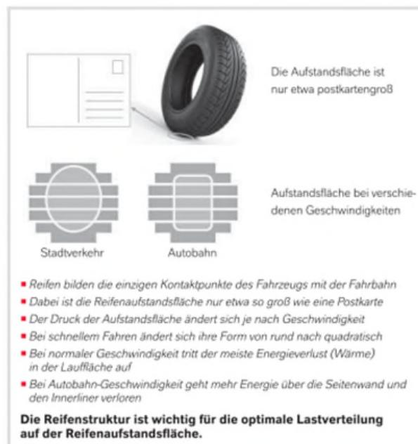
Bild 4: Geschwindigkeitsabhängige Aufstandsfläche nach [9].
