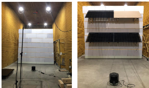
Abbildung 7: Einfluss vorgesetzter PV-Module auf die hochabsorbierende Lärmschutzwand. Messung im Halbfreifeldraum mit Vergleichsschallquelle in drei Höhen.
