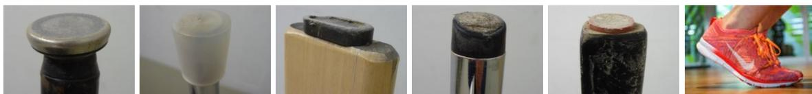
Die zufällig ausgewählten Stühle waren vierbeinig (Holz, Metall) und hatten unterschiedliche Stuhlgleiter (Kunststoff, Filz, Metall-Kunststoff). Als akustischer Vergleich diente ein Geher mit Sportschuhen. Erwartungsgemäß fallen die Schallpegel im unteren Raum geringer als oberhalb der Decke aus. Auch unterscheiden sich die Schallpegel je nach Stuhl bzw. Stuhlgleiter um bis zu 20 dB.
