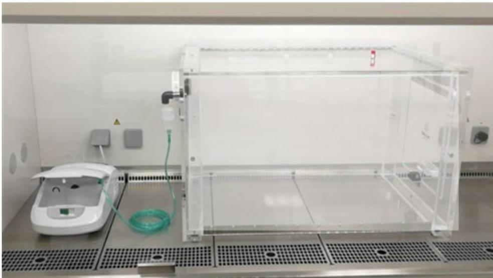
Bild 1: Testkammer des FhG-IGB, an die das UV-C-Luftentkeimungsrohr angeschlossen wird.
