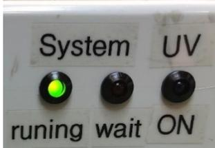
Bild 12: Ausschnitt Frontansicht Steuereinheit, System running, LED leuchtet.
