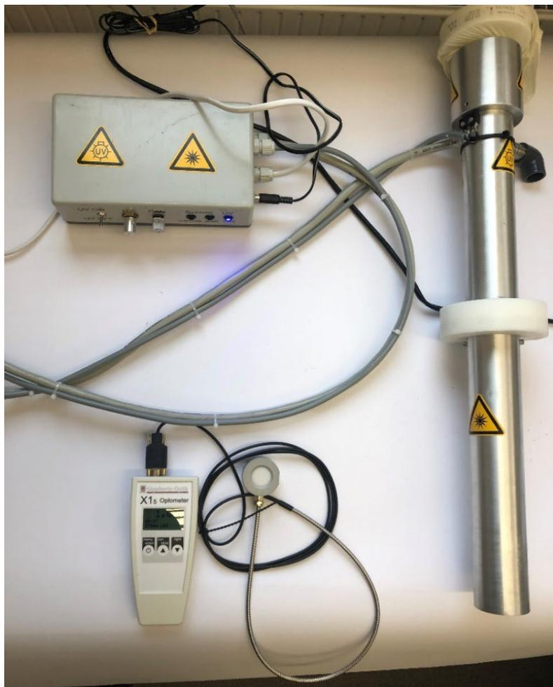
Bild 9: Gesamtaufbau des Rohres inkl. Steuereinheit und Strahlungsmessgerät.
