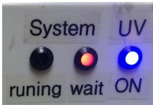
Bild 13: Ausschnitt Frontansicht Steuereinheit, System wait, LED und UV-LED leuchten.
