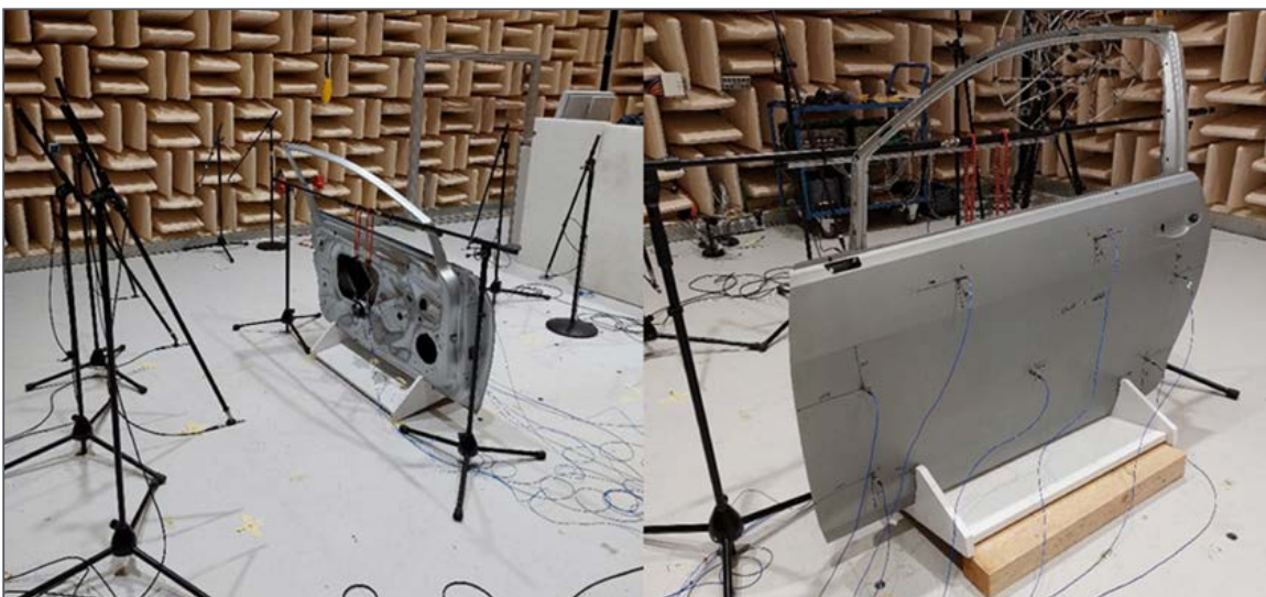
Abb. 9: Messaufbau zur vibroakustischen Charakterisierung der Rohkarosserietüren
