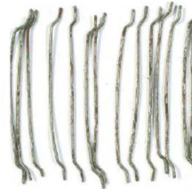
Durch eine elektrodynamische Fragmentierung können auch Stahlfasern aus Altbeton freigelegt werden
